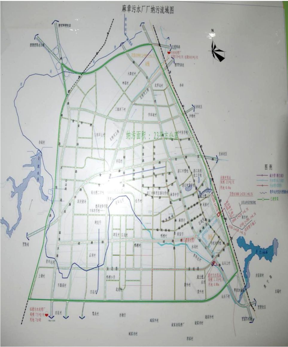
图 3-1 麻章镇污水收集管网现状图
