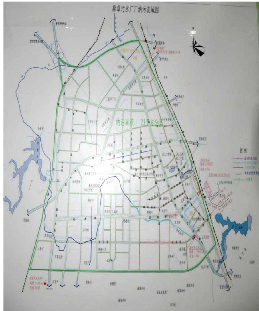
图 3-1 麻章镇污水收集管网现状图
